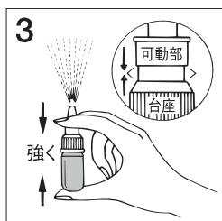
図のように指で支えて、可動部が止まるまで強く押し、この操作を数回くり返して薬液が霧状に噴射されることを確認してください。
